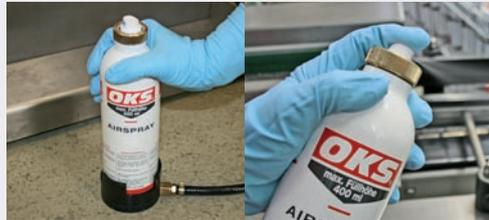
Quitar la tuerca tapón y llenar líquido. Introducir el tubo de subida, colocar la válvula con boquilla rociadora en el adaptador, enroscar y apretar la tuerca tapón con la mano. Poner el bote con la válvula en la estación de llenado. Empujar aprox. 2 segundos hacia abajo. Listo para rociar.
